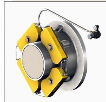
La unidad AMPS utiliza la Carga Activa para garantizar que se aplique una carga constante y precisa al conjunto de anillos de empaque. Estos tensores maximizarán el rendimiento del sellado realizando ajustes automáticos continuos para compensar la consolidación y el desgaste de los anillos de empaque.
